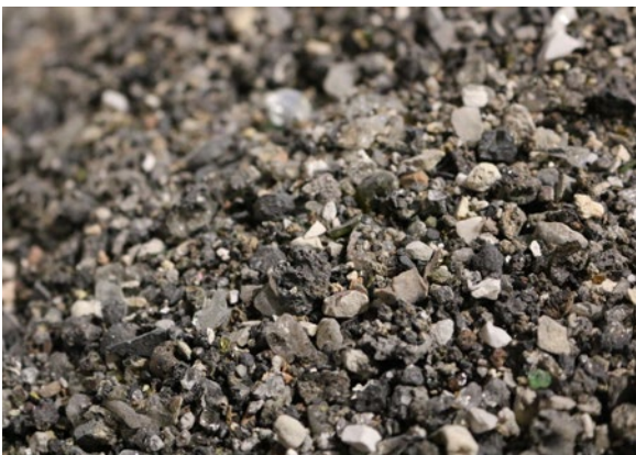
▲ Abb. 3 und 4: Eisenreiche magnetische (rechts) und kalziumreiche mineralische (links) Restschlacke aus der ZAV Recycling AG als zukünftige Rohstoffe in der Klinkerproduktion.
