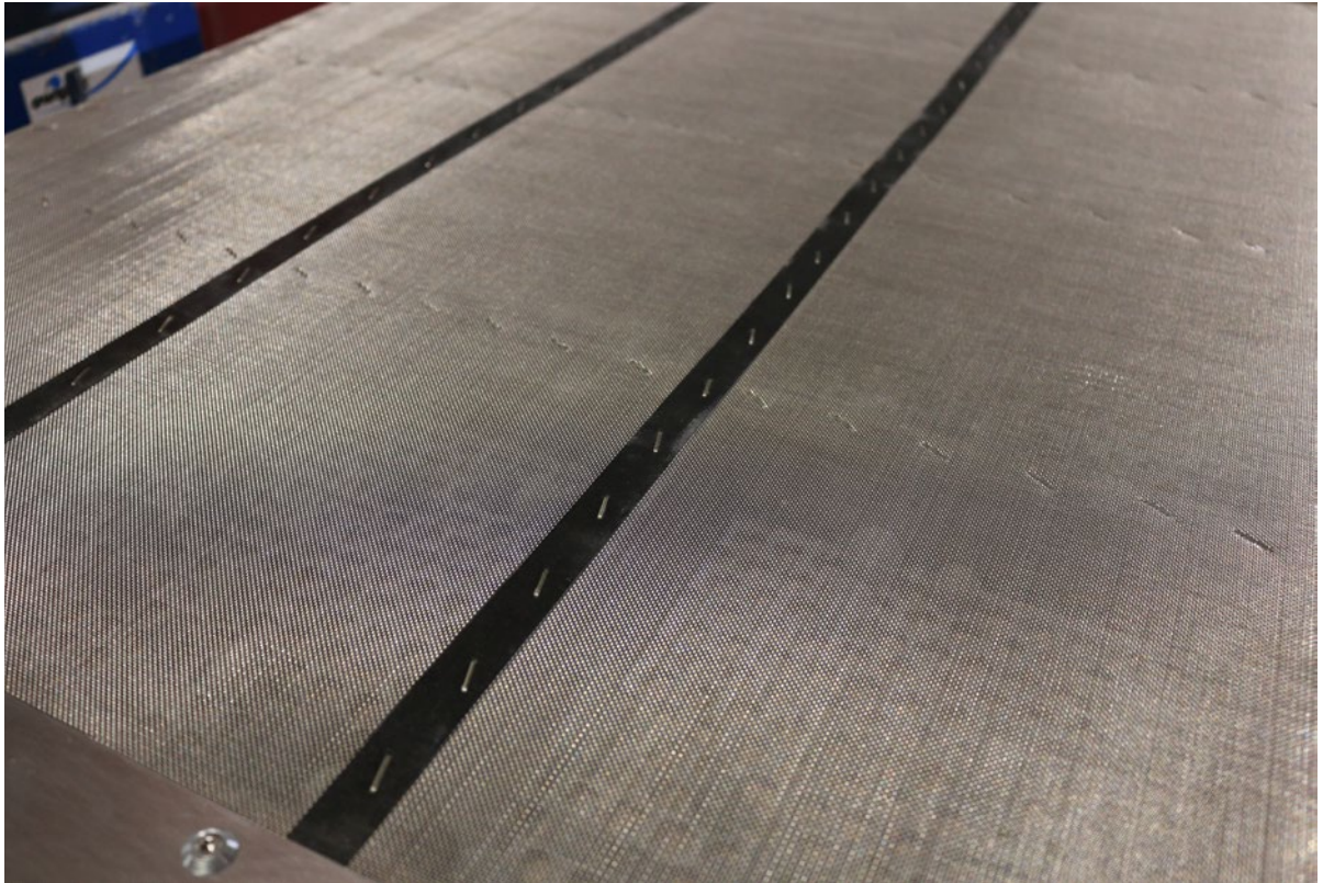
▲ Abb. 5: Siebauschnitt für Linear-Schwingsieb für Feinschlacke von Trockenschlackenaufbereitung in der ZAV Recycling AG.
