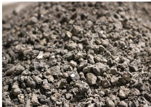
▲ Abb. 3 und 4: Eisenreiche magnetische (rechts) und kalziumreiche mineralische (links) Restschlacke aus der ZAV Recycling AG als zukünftige Rohstoffe in der Klinkerproduktion.
