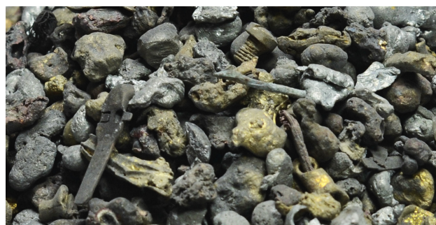
Wertvolle NE-Metalle (3–8 mm) direkt aus dem Separationsprozess
