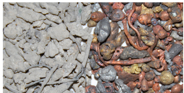
Links NE-Metalle aus Nassaustrag – rechts NE-Metalle aus Trockenaustrag
