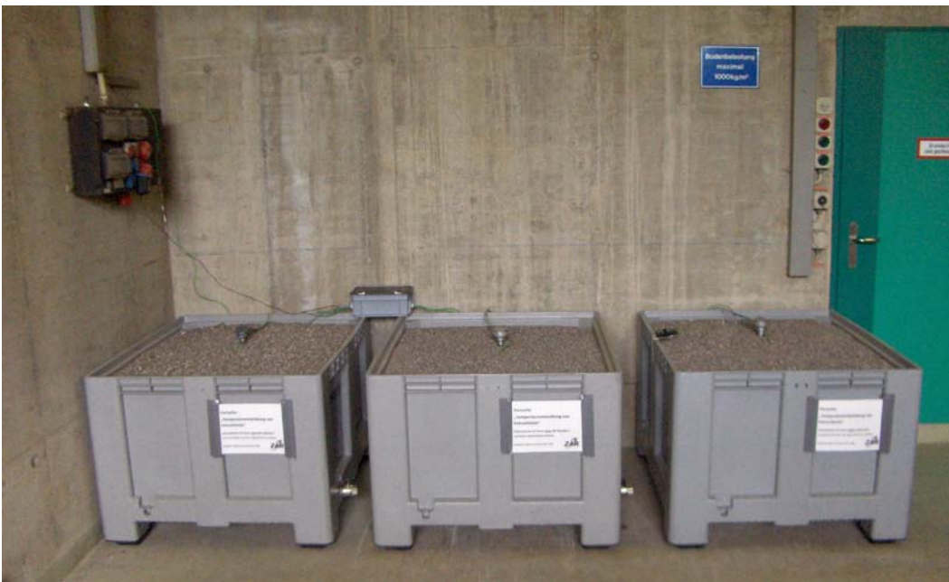
Bild 11: Deponierungsversuche mit Feinschlacke
