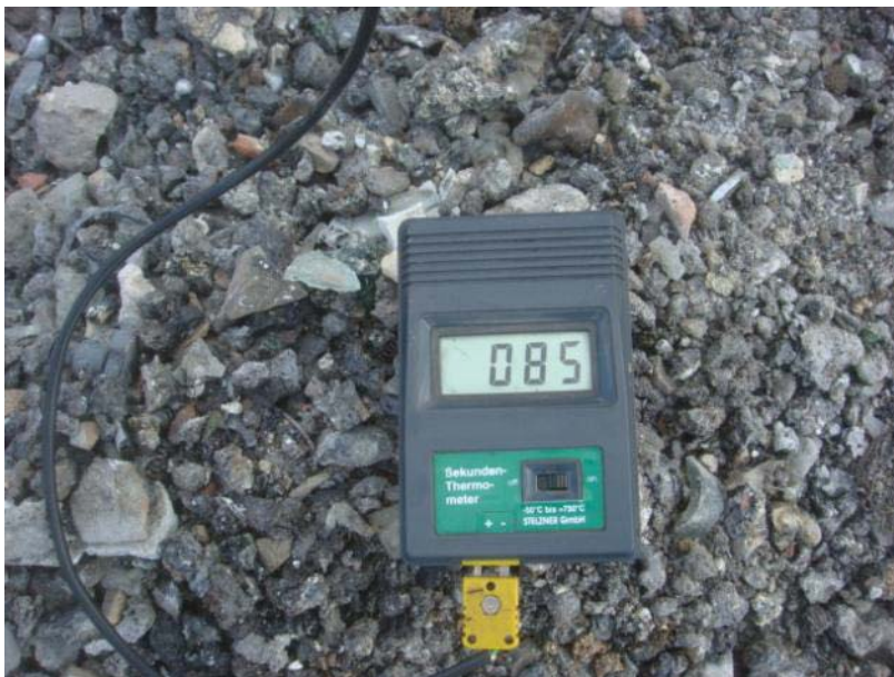
Bild 9: Temperaturmessung in der nassen Trockenschlacke
