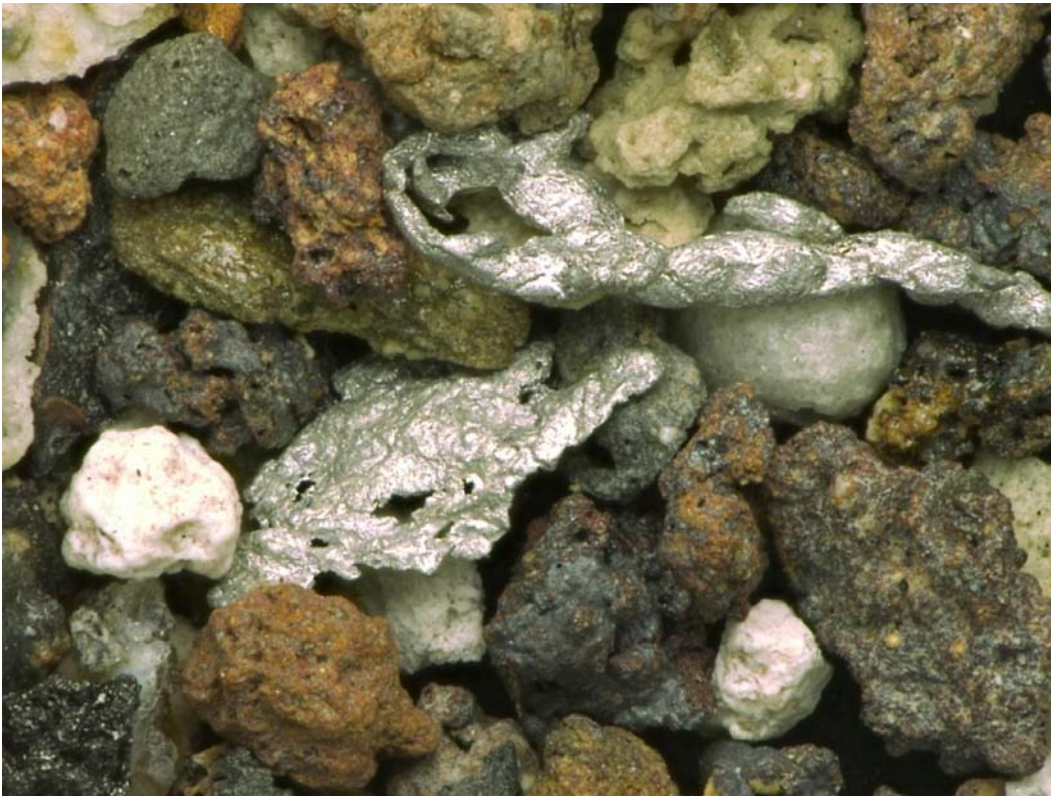
Bild 4: Wertstoffe in der Feinschlacke (Bildausschnitt 3.0 mm)
