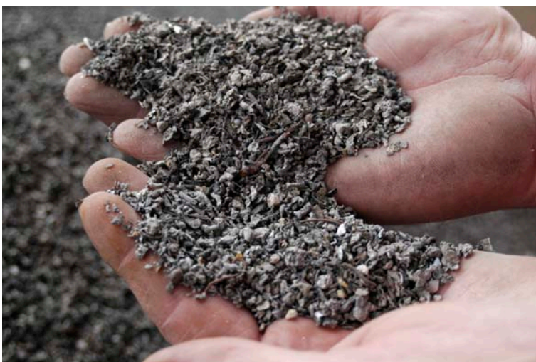
Bild 6: NE-Material aus der Feinschlacke (0.6 – 5.0 mm)
