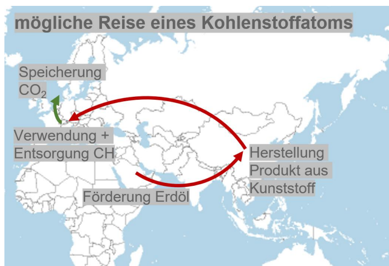
Abbildung 32: Beispielhafte Illustration möglicher Transportdistanzen eines Kohlenstoffatoms von der Förderung über die Herstellung eines Produkts bis zur Speicherung. Die Transportdistanz des bei der KVA abgeschiedenen CO 2 macht nur einen kleinen Teil der gesamten 'Reise' aus.
