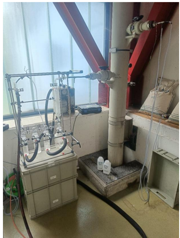
Abbildung 45, 46: Emissionsmessung am Abluftrohr des FLUWA-Abluftwäschers (links) und der Vakuumpumpe des FLUWA-Bandfilters (rechts)
