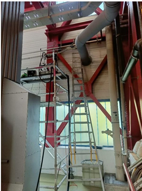
Abbildung 45, 46: Emissionsmessung am Abluftrohr des FLUWA-Abluftwäschers (links) und der Vakuumpumpe des FLUWA-Bandfilters (rechts)
