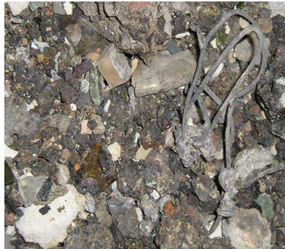
Abb. 32: Trocken ausgetragene Schlacke
