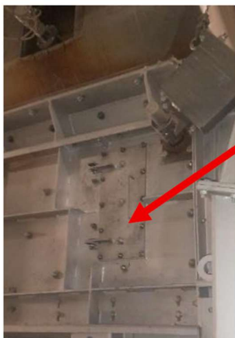
Abb. 15: Kleine Öffnung zum Lösen von Verstopfungen
