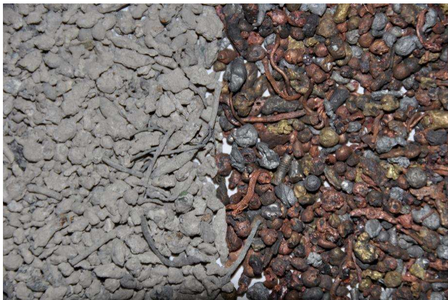
Abb. 17: NE-Metalle separiert aus Nassschlacke (links) und Trockenschlacke 1
