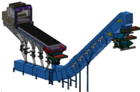
Abb. 4: Abzugsband mit Doppelklappe (Kanadevia Inova AG)
