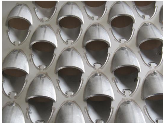
Abb. 10: Prototyp mit Lötverbindung
