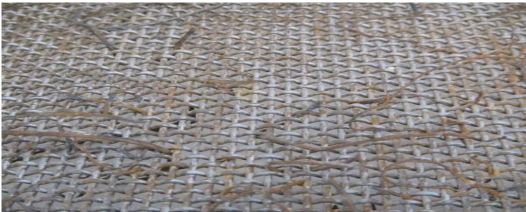
Abb. 1: Verhakte Drähte bei einem einfachen Maschensieb, bereits nach einem kurzen Einsatz in einem Trockenschlackenstrom. Dadurch sinken die Verfügbarkeit und die Produktqualität.
