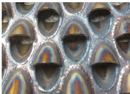
Abb. 9: Prototyp mit Schweissverbindung
