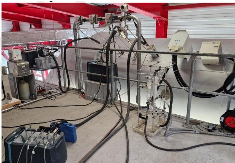
Abbildung 9: Isokinetische Probenahme im Abgaskanal der Ofenlinie 2 im Zuge der LRV-Emissionsmessung im Juni 2023.
