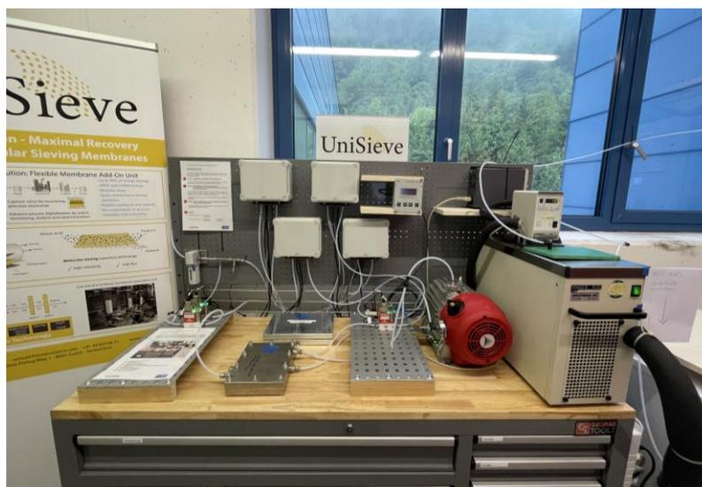
Abbildung 3: Membran-Testanlage der Firma UniSieve an der KVA Linth
